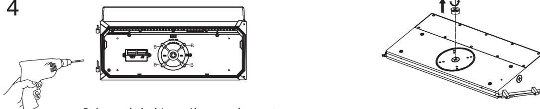
Préparez le boîtier arrière pour le montage en perçant ou en frappant le trou approprié.
