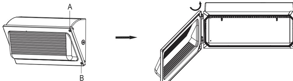
Desserrez les vis 2xM5 (A/B) et ouvrez le luminaire.
