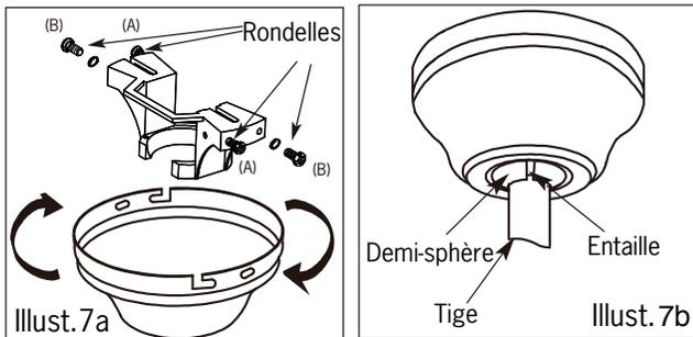
**N.B.:** Lorsque vous installez un ventilateur sur un plafond en pente, assurez-vous que l'entaille sur la ferrure soit face à la pente du plafond. Dépendant de l'angle de cette pente, une tige plus longue peut être requise afin d'empêcher les pales de cogner le plafond.
