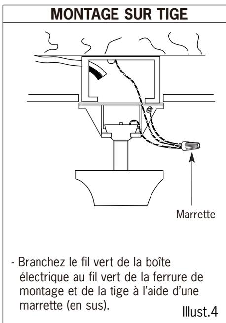
**N.B.:** Lorsque les fils sont branchés, pousser soigneusement les fils et la marrette dans la boîte électrique en vous assurant que les fils ne sont pas gênés par l'hémisphère ou la tige lorsque vous positionnez la ferrure de montage (pour installation avec tige seulement)
