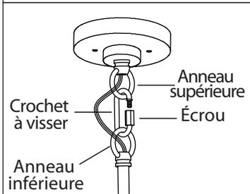
3. Dévisser le crochet et insérer les boucles inférieures et supérieures sur le crochet.
