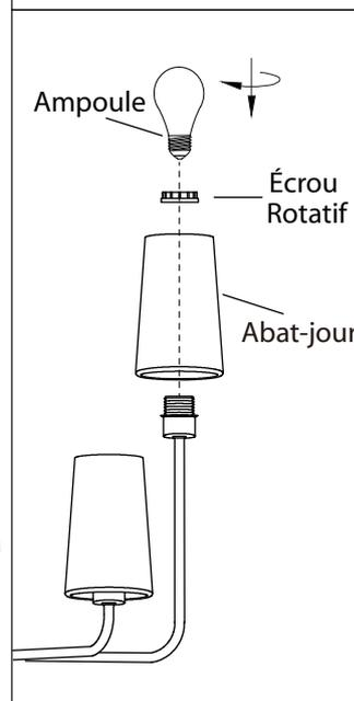
9. Retirez l'écrou rotatif de la douille. Positionnez l'abat-jour sur la lampe et fixez-le solidement avec l'écrou rotatif.
