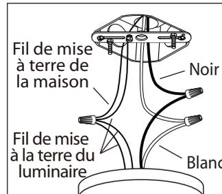
6. Branchez les fils de la mise a terre (cuivre nu ou vert) de votre montage au fil de la mise a terre (cuivre nu ou vert) ou vis de la mise a terre dans la boîte électrique. Posez le fil noir de la fixture au fil noir dans la boîte électrique et posez le fil blanc de la fixture au fil blanc dans la boîte.
