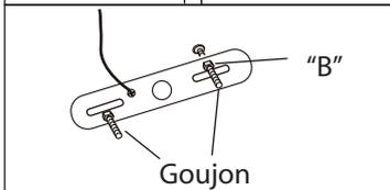
5. Posez la ferrure de montage à la boîte électrique à l'aide des vis de la boîte électrique (en sus). Assurez-vous que les goujons de la ferrure d'installation font face vers l'extérieur de la boîte électrique.
