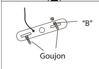
2. Dévissez l'écrou B. Ajustez le poteau à la longueur désirée et barrez en place avec cet écrou.
