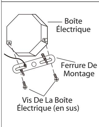
3. Posez la ferrure d'installation à la boîte de sortie électrique à l'aide des vis de la boîte (en sus). Assurez-vous que les goujons de la ferrure d'installation font face vers l'extérieur de la boîte électrique.
