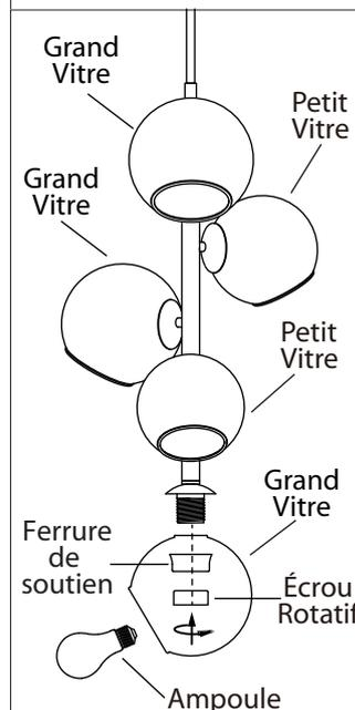
6. Placer le luminaire sur les goujons sur la ferrure de montage. Serrez le luminaire en place à l'aide des écrous étoilés et les écrous à capuchon.
