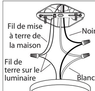
4. Branchez les fils de la mise a terre (cuivre nu ou vert) de votre montage au fil de la mise A terre (cuivre nu ou vert) ou vis de la mise a terre dans la boîte électrique. Posez le fil noir (ou fil ayant un écriteau) de la fixture au fil noir dans la boîte électrique et posez le fil blanc de la fixture au fil blanc dans la boîte.
