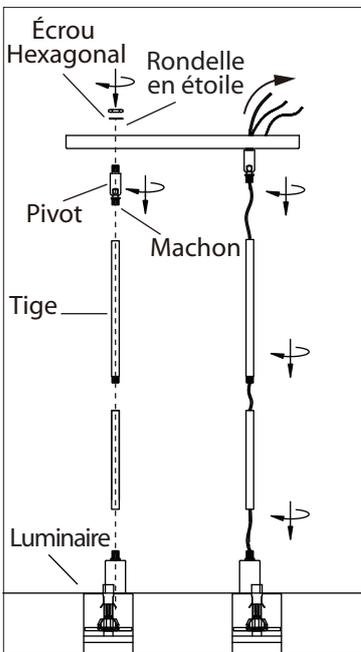
1. Installez la longueur de colonne requise en faisant passer le fil dans la colonne puis en vissant la colonne sur le luminaire. Installez le pivot sur la colonne en vous assurant que le manchon est au niveau du pivot.
