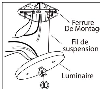
4. Utiliser le fil de suspension pour suspendre le luminaire tel qu'illustré afin de faciliter la connexion des fils.
