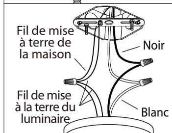
5. Branchez les fils de la mise a terre (cuivre nu ou vert) de votre montage au fil de la mise A terre (cuivre nu ou vert) ou vis de la mise a terre dans la boîte électrique. Posez le fil noir de la fixture au fil noir dans la boîte électrique et posez le fil blanc de la fixture au fil blanc dans la boîte.
