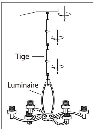
1. Installez la longueur de colonne requise en faisant passer le fil dans la colonne puis en vissant la colonne sur le luminaire. Vissez la canopé à la fixture.
