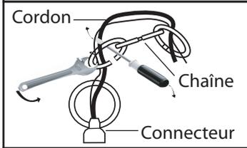
**5.** Pour relier la chaîne au luminaire, ouvrez l'un des maillons à l'aide d'un tournevis et d'une clé. Fermez le maillon. Enfillez le cordon électrique et le fil de la mise à la terre en travers des maillons de la chaîne.
