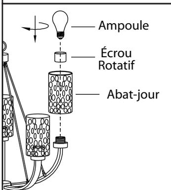
**10.** Retirez l'écrou rotatif de la douille. Positionnez l'abat-jour sur la lampe et fixez-le solidement avec l'écrou rotatif.
