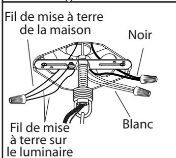
**7.** Brancher les fils de la mise à terre (cuivre nu ou vert) de votre luminaire au fil de la mise à terre (cuivre nu ou vert) ou vis de la mise à terre dans la boîte électrique. Poser le fil noir (ou fil marqué "SPT-1") de la fixture au fil noir dans la boîte électrique et poser le fil blanc (ou le fil rainuré) de la fixture au fil blanc dans la boîte.
