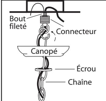
**6.** Dévissez l'écrou sur le connecteur supérieur et glissez-le vers le bas de la chaîne au connecteur inférieur. Glissez la plaque sur la chaîne vers le connecteur inférieur. Passez le fil à travers l'écrou, la plaque, le connecteur supérieur et sur le mamelon. Serrez le connecteur supérieur sur le mamelon. Écartez l'autre bout de la chaîne et attachez au connecteur supérieur. Fermez le maillon.
