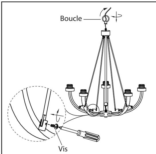
1. Serrer la boucle sur la tige du luminaire. Serrez les bras par le vis comme montrées.
