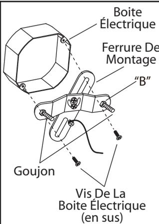
1. Dévissez l'écrou B. Ajustez le poteau à la longueur désirée et barrez en place avec cet écrou.
