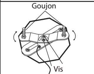
2. Posez la ferrure d'installation à la boîte de sortie électrique à l'aide des vis de la boîte (en sus). Assurez-vous que les goujons de la ferrure d'installation font face vers l'extérieur de la boîte électrique.
