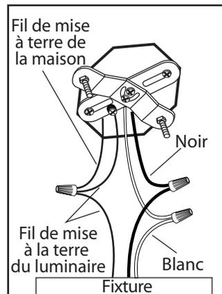
7. Brancher les fils de la mise à terre (cuivre nu ou vert) de votre luminaire au fil de la mise à terre (cuivre nu ou vert) ou vis de la mise à terre dans la boîte électrique. Poser le fil noir (ou fil marqué "SPT-1") de la fixture au fil noir dans la boîte électrique et poser le fil blanc (ou le fil rainuré) de la fixture au fil blanc dans la boîte.
