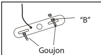
1. Dévissez l'écrou B. Ajustez le poteau à la longueur désirée et barrez en place avec cet écrou.
