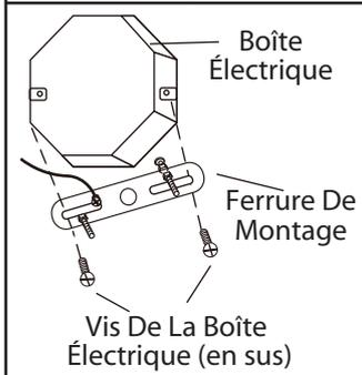
2. Posez la ferrure de montage à la boîte électrique à l'aide des vis de la boîte électrique (en sus). Assurez-vous que les goujons de la ferrure d'installation font face vers l'extérieur de la boîte électrique.
