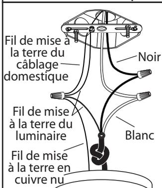
4. Branchez les fils de la mise a terre (cuivre nu ou vert) de votre montage au fil de la mise a terre (cuivre nu ou vert) ou vis de la mise a terre dans la boîte électrique. Posez le fil noir de la fixture au fil noir dans la boîte électrique et posez le fil blanc de la fixture au fil blanc dans la boîte.
