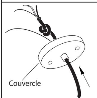
3. Ajuster la longueur du cordon flexible. Par précaution, ne défaites pas le noeud à l'intérieur du anopé.
