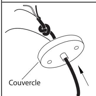
4. Ajuster la longueur du cordon flexible. Par précaution, ne défaites pas le noeud à l'intérieur du anopé.
