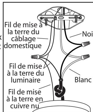
5. Branchez les fils de la mise a terre (cuivre nu ou vert) de votre montage au fil de la mise a terre (cuivre nu ou vert) ou vis de la mise a terre dans la boîte électrique. Posez le fil noir de la fixture au fil noir dans la boîte électrique et posez le fil blanc de la fixture au fil blanc dans la boîte.
