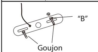
2. Dévissez l'écrou B. Ajustez le poteau à la longueur désirée et barrez en place avec cet écrou.
