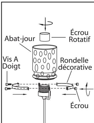
1. Tournez le luminaire à l'envers. Retirez l'écrou rotatif de la douille. Placer l'abat-jour sur la douille. Serrer les anneaux décoratifs à l'aide des vis à doigt et des écrous. Sécuriser l'abat-jour à l'aide de l'écrou fileté.
