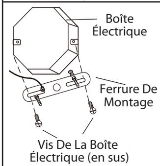
3. Posez la ferrure de montage à la boîte électrique à l'aide des vis de la boîte électrique (en sus). Assurez-vous que les goujons de la ferrure d'installation font face vers l'extérieur de la boîte électrique.
