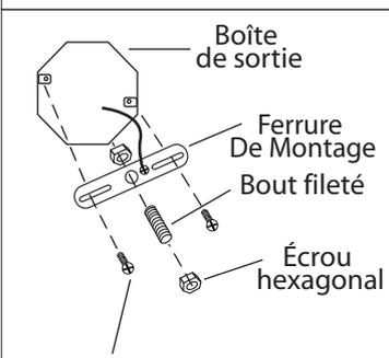
2. Attachez le support de montage dans la boîte de sortie en utilisant les vis de la boîte de sortie (non comprises). Posez le bout fileté au support de montage et ajustez jusqu'à ce qu'il dépasse la monture lorsqu'il est assemblé. (Posez la monture sur le bout fileté et vissez le connecteur supérieur sur le bout jusqu'à ce qu'il soit serré. Le connecteur supérieur devrait tenir la monture contre le plafond). Fixez le bout fileté à la bonne position à l'aide de l'écrou hexagonal.
