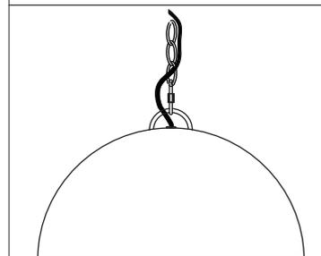
7. Glissez la monture le long de la chaîne et par dessus le connecteur supérieur. Glissez l'écrou le long de la chaîne sur le connecteur supérieur.
