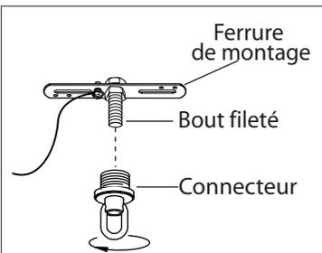
1. Déterminez la longueur à laquelle vous désirez suspendre votre luminaire. Coupez le cordon et la chaîne. Allouez environ 10 po de câblage supplémentaire pour les connexions à la boîte de sortie. Dévissez le connecteur supérieur du bout fileté sur le support de montage.
