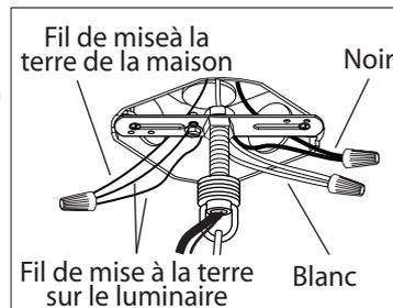
5. Reliez les fils de la mise à terre (cuivre nu ou vert) du luminaire au fil de la mise à terre (cuivre nu ou vert) ou vis de la mise à terre dans la boîte de sortie. Reliez le fil noir (ou fil marqué « SPT-1 ») du luminaire au fil noir dans la boîte de sortie et reliez le fil blanc (ou le fil rainuré) du luminaire au fil blanc dans la boîte de sortie.
