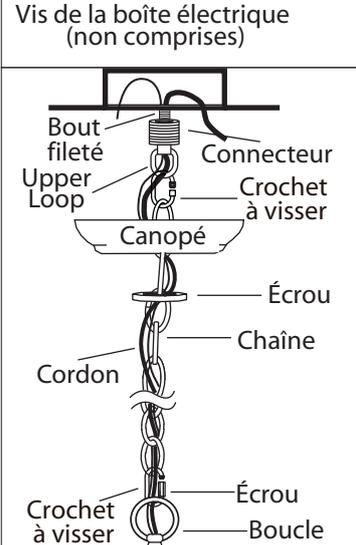
3. Connectez la chaîne à la boucle et la boucle supérieure au connecteur supérieur à l'aide du crochet à deux vis.
