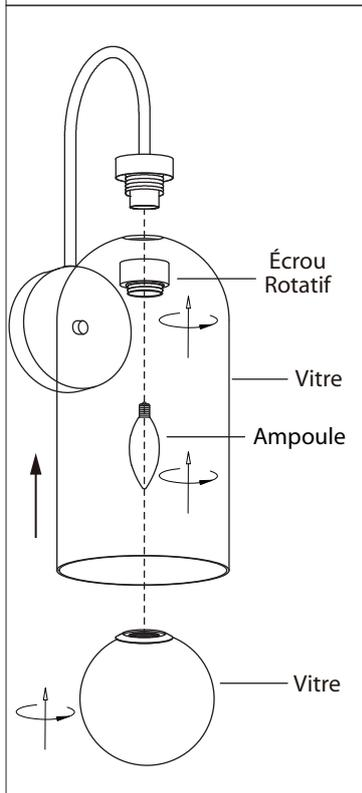
5. Retirez l'écrou fileté de la douille. Posez le globe sur la lampe et serrez en place à l'aide de l'écrou fileté. **(Bien vérifier le verre avant l'installation pour tout défaut ou craque. Ne pas trop serrer l'anneau pour installer le verre au luminaire.)**
