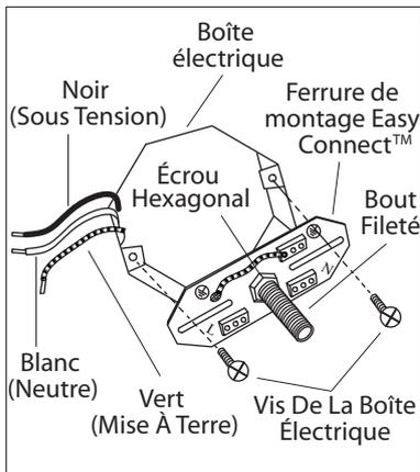
1. Posez le bout fileté à la ferrure de montage. Ajustez le jusqu'à ce qu'il dépasse le trou à l'arrière de la fixture et fixez en place à l'aide de l'écrou hexagonal. Posez la ferrure de montage à la boîte électrique à l'aide des vis (en sus).
