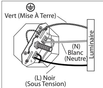
3. Branchez (poussez) les fils électriques du luminaire dans les insertions appropriées.
