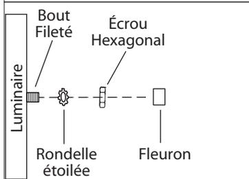
4. Une fois les connexions terminées, poussez soigneusement les fils et les connecteurs dans la boîte électrique en vous assurant qu'aucun fil dénudé (sur les fils noirs et blancs) est visible des connecteurs. Posez le plateau au bout fileté en serrant à l'aide des écrous étoilés et des écrous hexagonaux. Vissez le fleuron au bout fileté.
