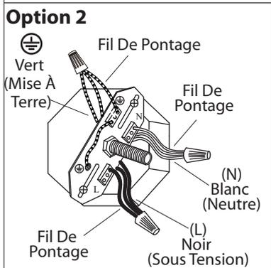
**Option 2:** Lorsqu'il y a des multiples de fils dans la boîte électrique, vert (mise à terre), noir (sous tension), blanc (neutre), poser seulement qu'un de chaque fil soit vert, noir et blanc avant pour la connexion. Retirez 7mm de la gaine d'un fil de pontage de 6" inclus. Posez (poussez) les fils dans les insertions appropriées.
