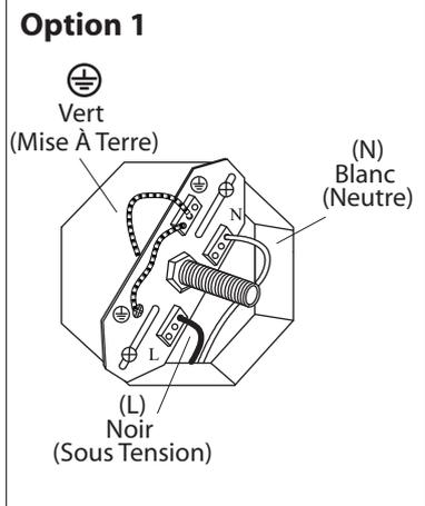
2. **Option 1:** Poussez pour brancher les fils de la boîte électrique (courant de la maison) dans les insertions appropriées.
