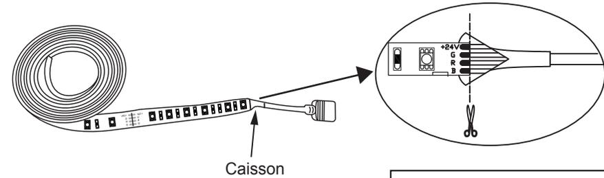
2. BRANCHEZ - utilisez les connecteurs pour brancher le ruban d'éclairage. Insérez le bout du ruban et assurez-vous que la plaque soudée plate est bien insérée dans le connecteur.
