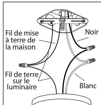
3. Branchez les fils de la mise a terre (cuivre nu ou vert) de votre montage au fil de la mise a terre (cuivre nu ou vert) ou vis de la mise a terre dans la boîte électrique. Posez le fil noir de la fixture au fil noir dans la boîte électrique et posez le fil blanc de la fixture au fil blanc dans la boîte.
