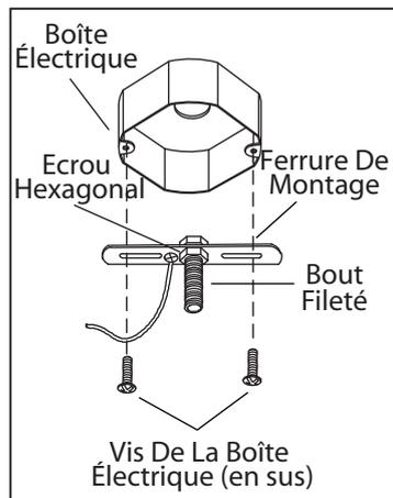
1. Posez le bout fileté à la ferrure de montage et ajuster pour qu'il dépasse un peu de la fixture lors du montage. Posez la ferrure d'installation à la boîte de sortie électrique à l'aide des vis de la boîte (en sus).
