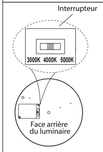
2. Utilisez l'interrupteur à glissière pour choisir une température de couleur. Les options sont 3000K, 4000K et 5000K.
