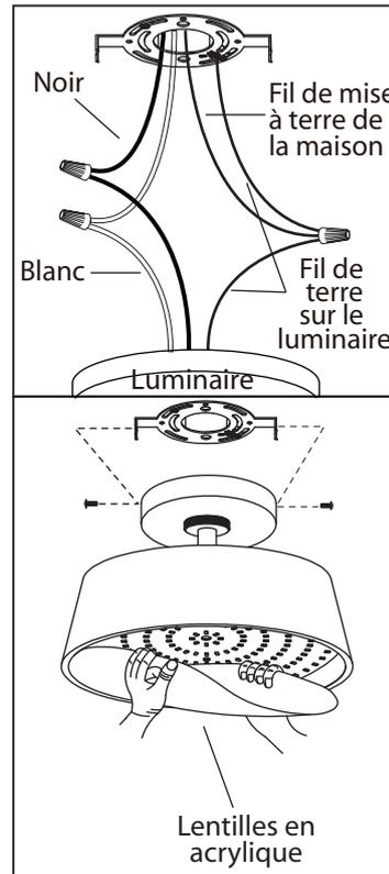
3. Branchez les fils de la mise a terre (cuivre nu ou vert) de votre montage au fil de la mise a terre (cuivre nu ou vert) ou vis de la mise a terre dans la boîte électrique. Posez le fil noir de la fixture au fil noir dans la boîte électrique et posez le fil blanc de la fixture au fil blanc dans la boîte.
