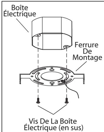
1. Posez la ferrure d'installation à la boîte de sortie électrique à l'aide des vis de la boîte (en sus).
