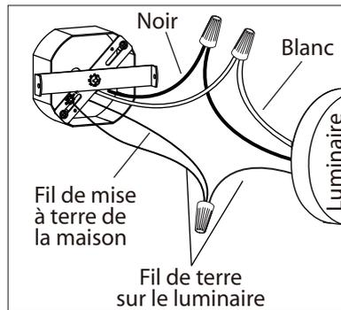
3. Branchez les fils de la mise a terre (cuivre nu ou vert) de votre montage au fil de la mise a terre (cuivre nu ou vert) ou vis de la mise a terre dans la boîte électrique. Posez le fil noir de la fixture au fil noir dans la boîte électrique et posez le fil blanc de la fixture au fil blanc dans la boîte. **N.B.; Ne pas défaire les connexions déjà existantes.**
