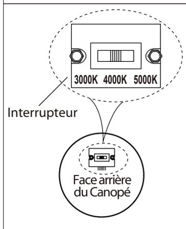
2. Utilisez l'interrupteur à glissière pour choisir une température de couleur. Les options sont 3000K, 4000K et 5000K.
