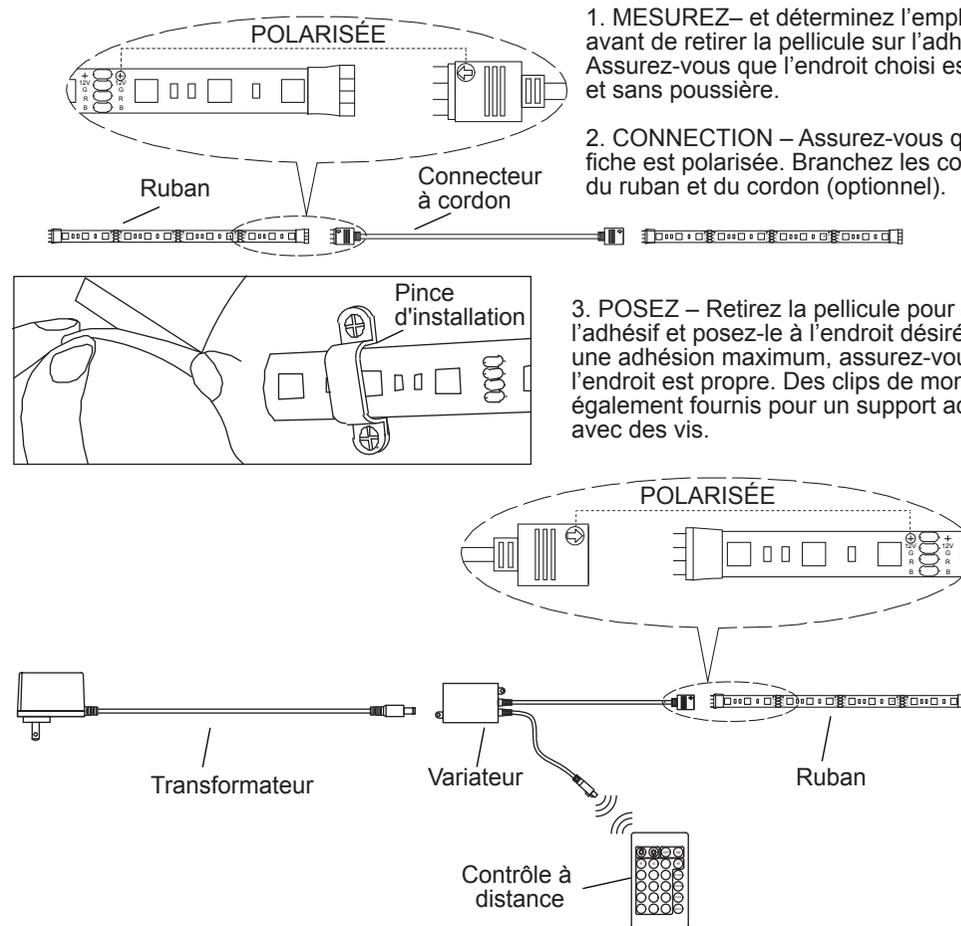
Votre contrôle à distance est maintenant prêt à être utilisé. Pour utiliser le contrôle RGB, assurez-vous que vous n'êtes pas à plus de 8 mètres du variateur. Le Contrôle à distance RGB peut effectuer plusieurs variations et d'effets de couleurs. (clignotement, stroboscopie, effacement, etc..)
