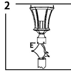
2. Fixer le luminaire à la tige avec la vis de tige (E).
