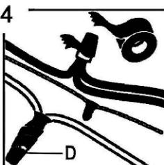
4. Attacher les capuchons de connexion (D). Attacher les capuchons (D) et les fils ensemble avec du ruban isolant.
