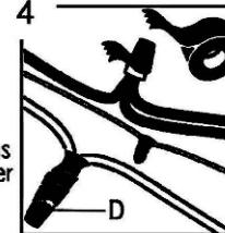
4. Attacher les capuchons de connexion (D). Attacher les capuchons (D) et les fils ensemble avec du ruban isolant.
