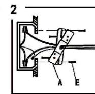
2. Conecte la barra de montaje(A) a la caja de salida usando los tornillos de montaje(E).
