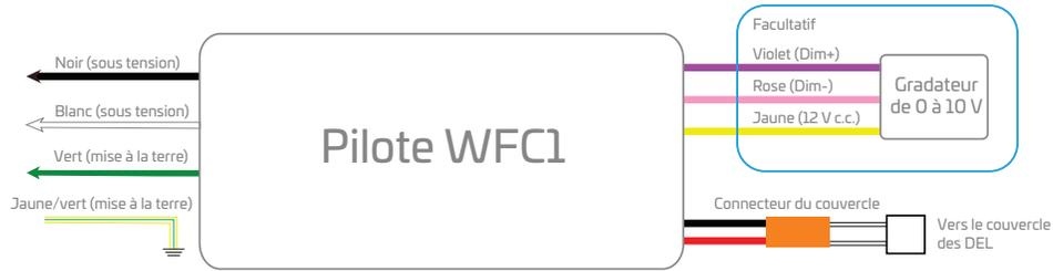
Remarque : Si vous raccordez une batterie de secours au luminaire, reportez-vous au schéma de câblage inclus avec celle-ci.
