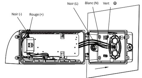
**6** Raccordez le fil d'entrée et le fil de gradation du luminaire, puis insérez les fils raccordés dans la boîte de jonction encastrée.
