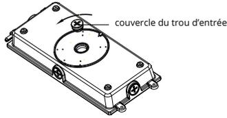
**2** Dévissez le couvercle du trou d'entrée situé sur la base du luminaire, puis retirez-le.
