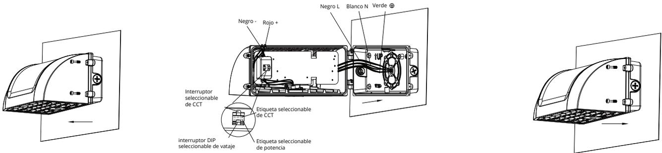
**1** Use un desarmador para desatornillar los tornillos de la lámpara y remover la parte superior del accesorio.
