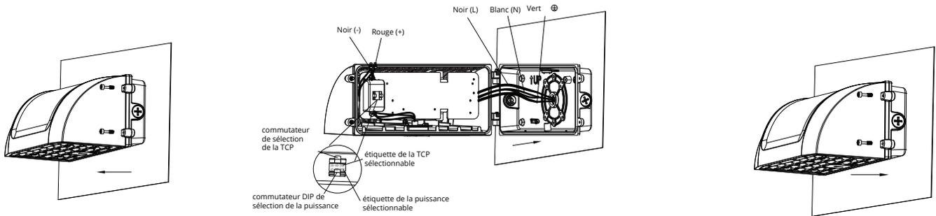
**1** À l'aide d'un tournevis, dévissez les vis du luminaire, puis retirez la partie supérieure du luminaire.
