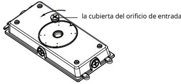
**2** Desatornille la cubierta del orificio de entrada en la base de la lámpara y remueva la cubierta.
