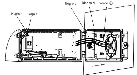
**6** Conecte el cable de entrada y el cable de atenuación de la luz, y luego ponga los cables conectados en la caja de terminal integrada.
