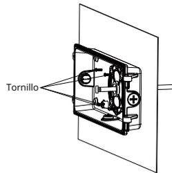
**5** Use el tornillo para bloquear la base de la lámpara en la caja de conexiones integrada.
