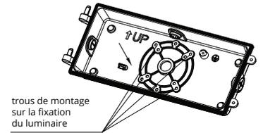
**3** Dévissez le couvercle du trou d'entrée situé sur la base du luminaire, puis retirez-le.
