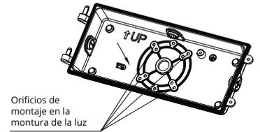
**3** Desatornille la cubierta del orificio de entrada en la base de la lámpara y remueva la cubierta.
