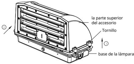
**1** Use un desarmador para desatornillar los tornillos de la lámpara y remover la parte superior del accesorio.
