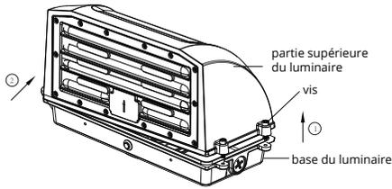
**1** À l'aide d'un tournevis, dévissez les vis du luminaire, puis retirez la partie supérieure du luminaire.
