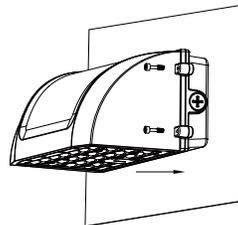
**8** Use los tornillos para bloquear el accesorio. Instalación completada.
