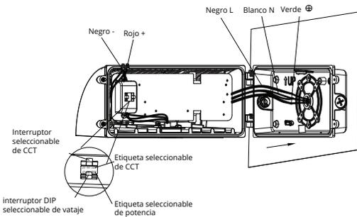
**7** Después de completar el cableado, configure el valor de CCT y de potencia mediante los interruptores internos. Conforme a la etiqueta, los usuarios pueden seleccionar el valor deseado de temperatura de color y de potencia.
