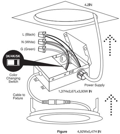
✓ **SUITABLE FOR WET LOCATION. ACCESS ABOVE CEILING REQUIRED.**
