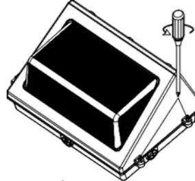
2. À l'aide d'un tournevis, desserrer les vis
