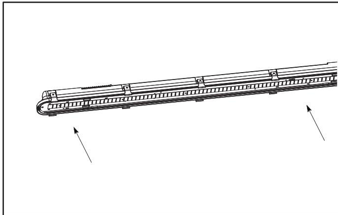
9. Attacher la lentille au boîtier avec les loquets de lentille.
