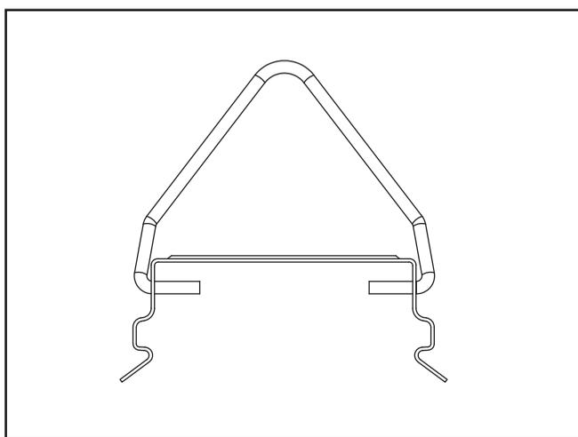
2. Fixer les pinces de montage dans les encoches du boîtier en les appuyant fermement en place jusqu'à ce que les deux côtés de la pince soient fixés. Accrocher le luminaire avec la chaîne fournie par le client à l'aide des supports en V.
