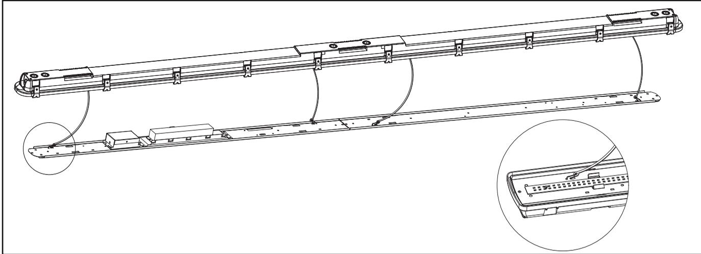
6. Connecter le câble d'alimentation au pilote à travers le boîtier de sortie comme illustré dans la figure (le cordon flexible est fourni par le client), s'assurer de remettre le couvercle du boîtier de sortie après avoir réalisé le câblage.
