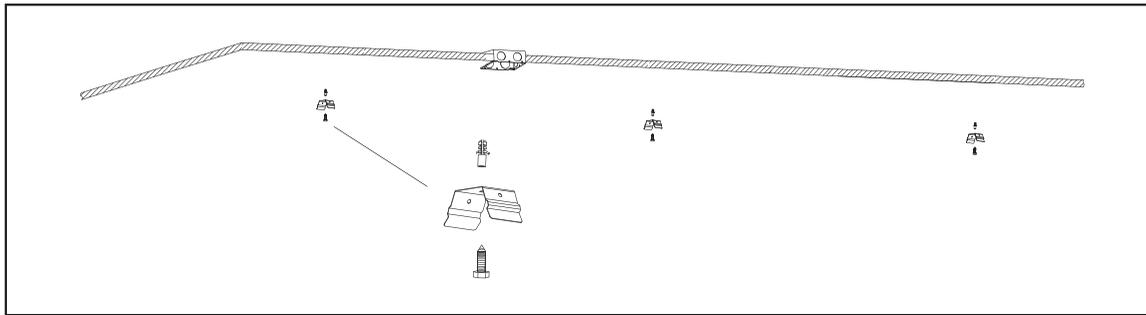
2. Fixer les pinces de montage dans les encoches du boîtier en les appuyant fermement en place jusqu'à ce que les deux côtés de la pince soient fixés.
