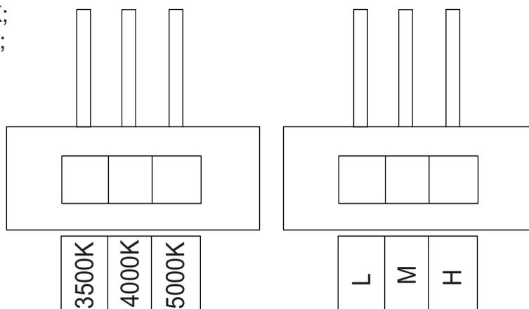
Les utilisateurs finaux peuvent régler la température de couleur et le rendement lumineux respectivement en utilisant les deux commutateurs DIP. Chaque commutateur DIP a 3 options (gauche, milieu et droite), correspondant à 3 températures de couleur et à 3 niveaux de puissance respectivement, qui peut effectuer la combinaison désirée de température de couleur et rendement lumineux.
