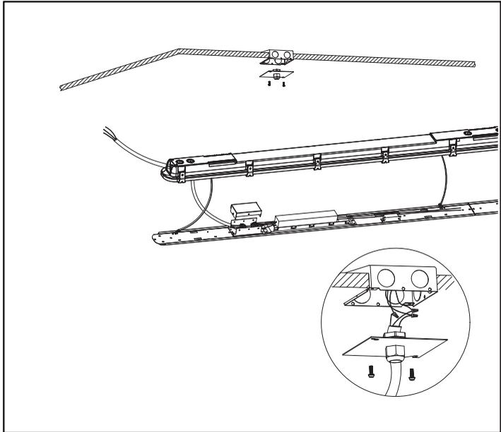
9. Rattacher le plateau à LED au luminaire en suivant l'étape 5 en ordre inverse.
