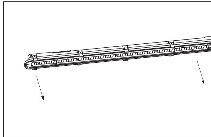
6. Localiser le câble de sécurité lors de l'ouverture pour installer le corps du luminaire et connecter le câble au plateau du matériel avant d'effectuer les connexions électriques comme illustré dans la figure.
