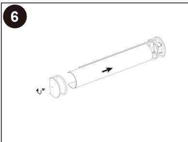
Fixer la lentille et l'anneau sur le boîtier du luminaire en serrant la vis de montage.
