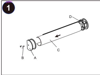
Retirer l'anneau (A) de l'appareil en desserrant la vis de montage (B), puis enlever la lentille (C) du boîtier du luminaire (D).
