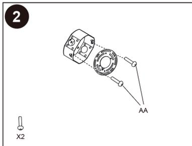
Insérer les longues vis (AA) dans les trous alignés et bien serrer.
