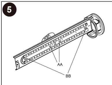
Placer le boîtier du luminaire (A) au dessus de la boîte de jonction, mettre la longue vis (AA) à travers la longue fente du trou du boîtier du luminaire (A), et l'enfiler dans la boîte de sortie. Aligner les trous de serrure sur le plateau du luminaire (A) avec les longues vis, puis déplacer le boîtier du luminaire jusqu'à ce que les longues vis (BB) viennent en contact avec l'extrémité étroite des trous de serrure. Serrer les vis (AA et BB) pour sécuriser.
