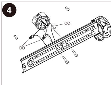
Connecter les fils du luminaire avec les fils d'alimentation: noir au noir, blanc au blanc, vert au cuivre/nu/sortie avec une vis de mise à la terre (CC).
