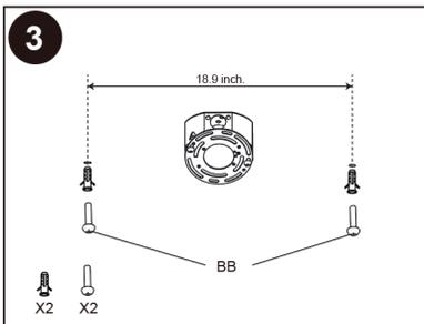
Positionner l'appareil sur la boîte de jonction et marquer l'emplacement des deux fentes de trou de serrure situées sur le boîtier du luminaire. S'assurer de ne marquer que les parties étroites, puis percer deux trous à l'aide d'un foret de taille appropriée. Insérer les ancrages fournis dans les trous, puis insérer les longues vis (BB) dans les ancrages en laissant environ 1" d'espace entre la têtes des vis et les ancrages.
